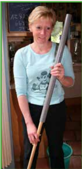
Buis (bevestigd met een washandje) om de lengte van de steel te vergroten
