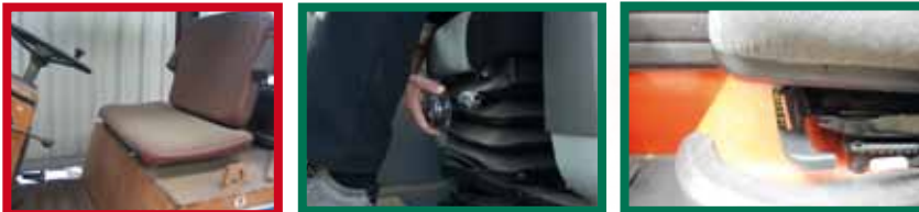
Pour réduire considérablement les vibrations transmises au dos il est recommandé de disposer d'un siège à suspension. Pour les amortisseurs de type mécanique, le réglage du siège du conducteur doit se faire en fonction du poids de ce dernier.
