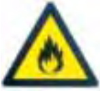
Matières inflammables ou haute température
