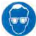
Protection obligatoire de la vue
