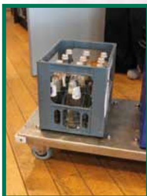
Chariot adapté au transport des casiers, avec des ergots évitant le glissement intempestif
