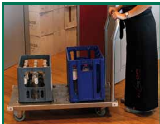
Chariot adapté au transport des casiers, avec des ergots évitant le glissement intempestif
