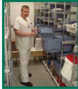
Stockage réfléchi qui facilite l'accès et évite de devoir prendre des postures contraignantes pour accéder aux objets (caisse avec couvercle en 2 parties pour avoir accès au contenu sans la tirer complètement).
