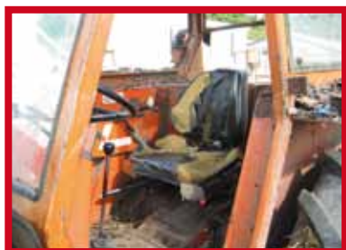
Les vibrations produites par un engin roulant sont encore aggravées si le siège et les systèmes de suspension du véhicule sont dans un état vétuste
