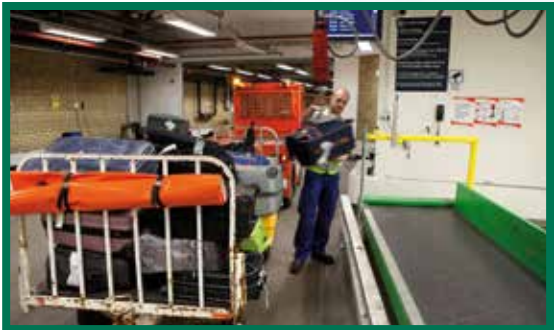
Utiliser une bande transporteuse pour le déplacement des colis jusque dans la remorque
