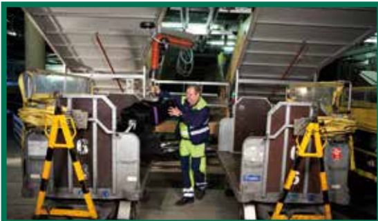
L'emploi d'un système d'aspiration (Vacuum) réduit considérablement les contraintes de manutention
