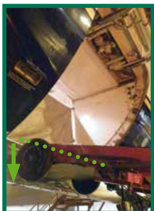
Position du beltloader pour le déchargement en dessous du seuil de soute
