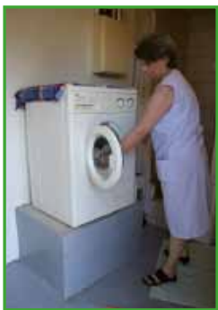
Machine à laver placée sur un socle
