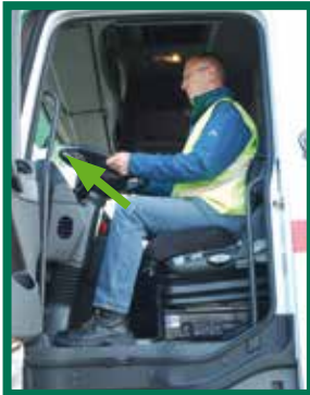
Volant réglable en inclinaison
