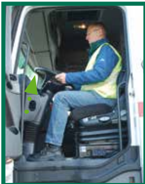
Volant réglable en profondeur
