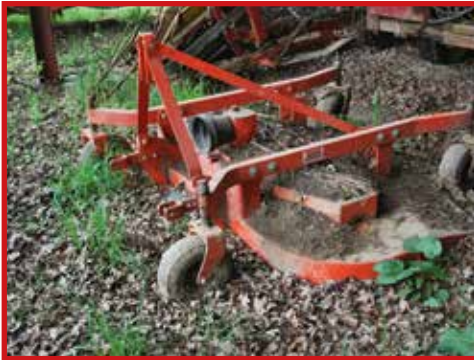
Chariot permettant de faciliter l'accrochage de la tondeuse au tracteur, en la positionnant à bonne hauteur par rapport au système d'arrimage
