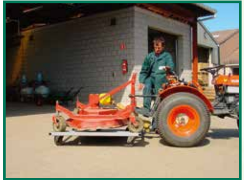
Chariot permettant de faciliter l'accrochage de la tondeuse au tracteur, en la positionnant à bonne hauteur par rapport au système d'arrimage
