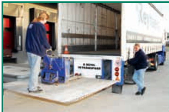
Les hayons automatisés facilitent l'accès au plancher des remorques
