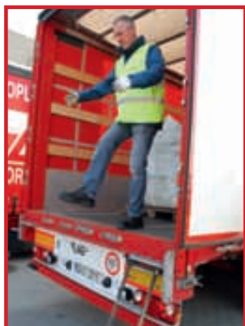
Les hayons automatisés facilitent l'accès au plancher des remorques
